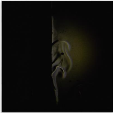
Figura 5. Foto tomada con navaja vertical ( T_0 = 21^\circ\text{C} ). Canon EOS REBEL T5. Exposición 4000^{-1}\text{s} , ISO 400.
