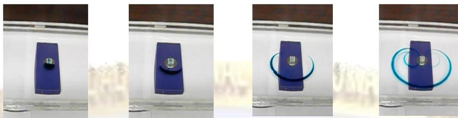
En este caso se observa la formación de vórtices partiendo de una línea fina de colorante que avanza en dirección perpendicular al campo eléctrico
